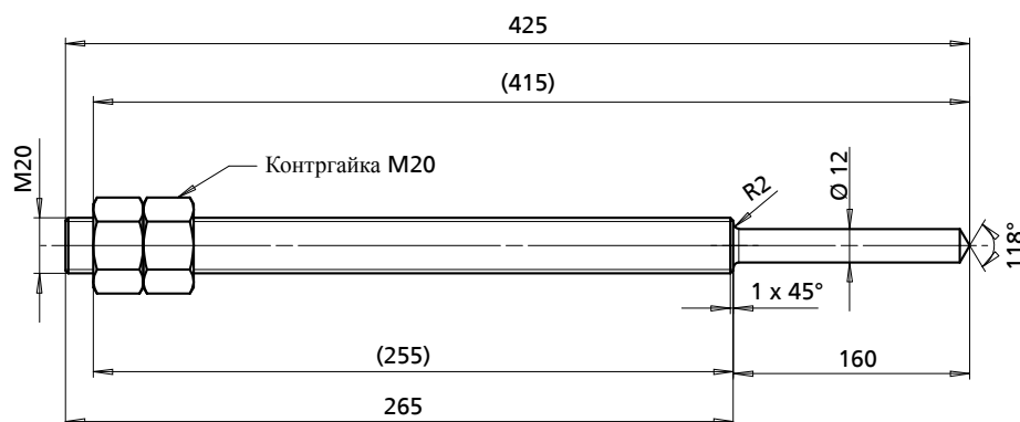
Рис. 36: Отжимной винт M20 × 425
